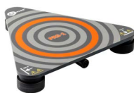
Sensore per misure della resistenza dei pavimenti e delle pareti PRS-1 WASONPRS1GB
